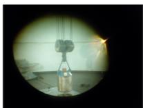
図C13. 放射線源が露出している様子。中央やや下にフィルターと同じ高さにある棒状の放射線源が見える。
