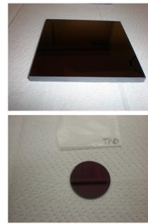
図C1. 80 mm角の製品フィルター (上)と25 mmΦのテストピース (下)
