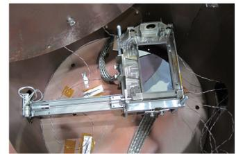
冷却試験チャンパー内に収められたフリップ式フィルタ交換機構試作品
